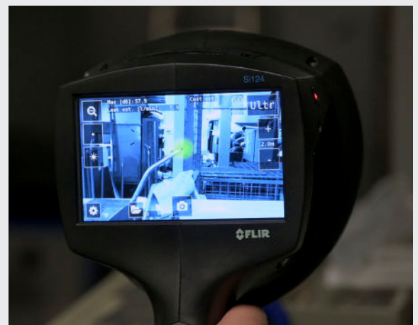
Die Kamera für die akustische Bildgebung FLIR Si124 zur Erkennung von Druckluftlecks
