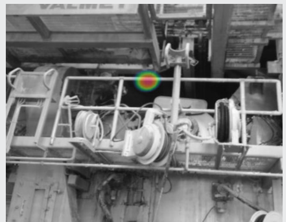
Die FLIR Si124 erkennt ein Druckluftleck
