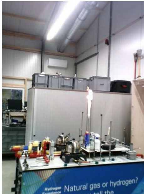
Ein Testaufbau mit Erdgas- und Wasserstoffackeln: Mit einer visuellen Kamera sind die Wasserstoffackeln nicht oder kaum sichtbar. Eine Wärmebildkamera kann diese jedoch anhand der Wärmestrahlung, die die Wasserstoffackeln aussenden, sichtbar machen.
