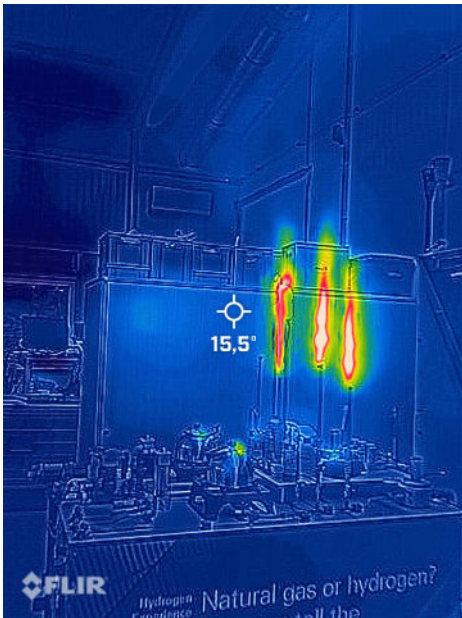
Ein Testaufbau mit Erdgas- und Wasserstoffackeln: Mit einer visuellen Kamera sind die Wasserstoffackeln nicht oder kaum sichtbar. Eine Wärmebildkamera kann diese jedoch anhand der Wärmestrahlung, die die Wasserstoffackeln aussenden, sichtbar machen.
