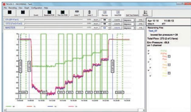
Mit der POR-Funktion werden definierte Messperioden automatisch aufgenommen
